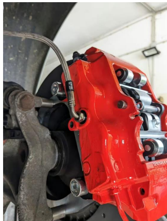
Bild 8: Anbau Betriebsbremse HA
